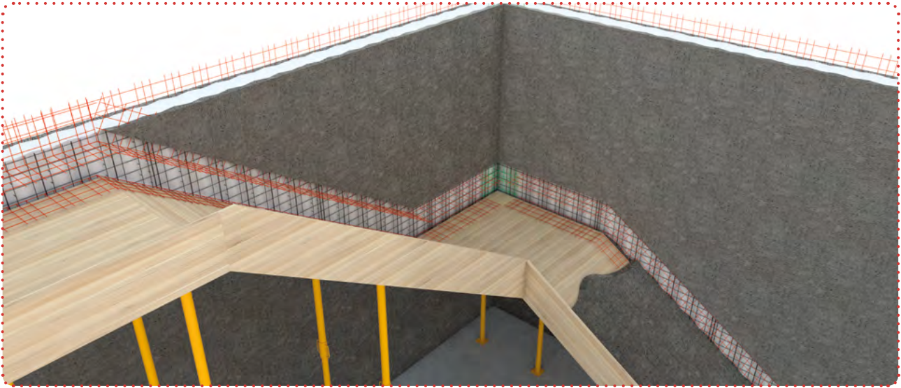
Vertido inferior de hormigón sobre encofrado
